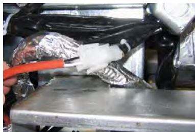
Abbildung 6: Befestigen Sie die zweipoligen weißen Steckverbinder und stecken Sie den schwarzen Steckverbinder wie dargestellt in die Versorgungsdose. * Bitte beachten Sie, dass die Position des schwarzen Steckverbinders vom Foto abweichen kann.
