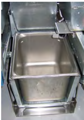
Abbildung 3: Die innere Fettbehälterwanne in die Schmelzeinheit einsetzen.
