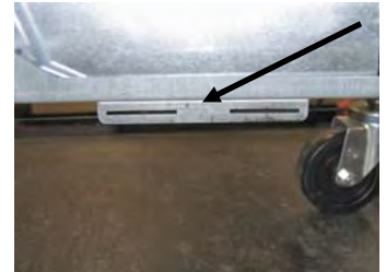
Abbildung 1: Befestigen Sie Ausrichtungshalterung am Boden der ATO-Gehäusestrebe.
