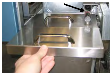
Abbildung 4: Den Deckel auf die Wanne setzen und das Fettsaugrohr in die Saugbuchse stecken.
